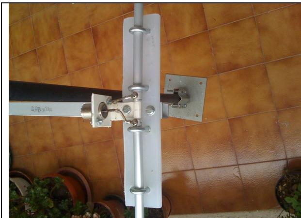
Particolare del Radiatore con il rinforzo interno, e bocchettone per l'antenna, non è previsto alcun tipo di balun. Da notare le due viti che collegano la piastra isolante con il boom. La seconda piastra isolante è mantenuta al boom con lo stesso sistema, l'unica differenza è che non c'è soluzione di continuità nel riflettore, che in pratica non è diviso in due come per il radiatore.
